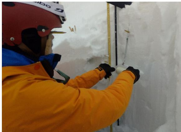
**Bild 3. Schneeprofil zur Messung der Eigenschaften der verschiedenen Schneeschichten bei der Identifikation potenzieller Schwachschichten(©ICGC).**
